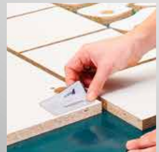
Etikettieren für die automatisierte Weiterbearbeitung
