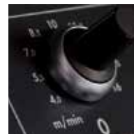
Stufenlos regelbare Vorschubgeschwin- digkeit 4–16 m/min
