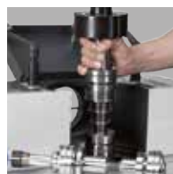
Frässpindel- Schnellwechsel- System
