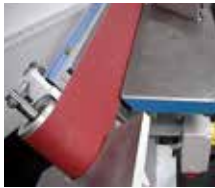
Schwenkung des Aggregates 90-45°
