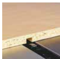
Nuten mit der Kreissäge
