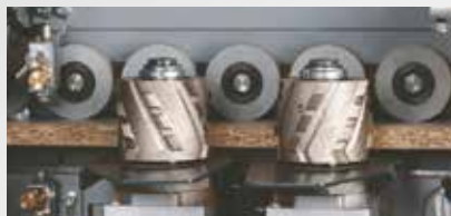
2 Fügeaggregat mit Diamantfräsern
