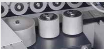
5 Anpresseinheit mit einer Druckrolle und 2 konischen Nachpressrollen
