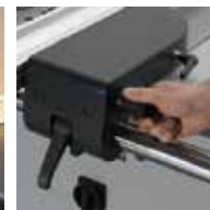
Parallelanschlag mit integrierter Feineinstellung
