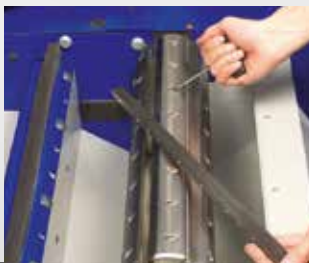
Standard: Hobelmesser-Einstellung ohne Werkzeug
