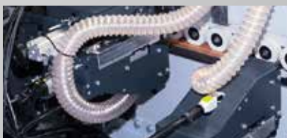
8 Eckenrundungsaggregat (Option: 2 mot. Eckenrundungsaggregat)
