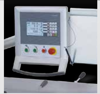
Positioniersteuerung für Parallelanschlag
