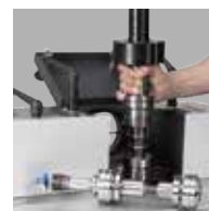
Frässpindel- Schnellwechsel- System
