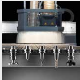
8- oder 10-fach Werkzeugwechsler
