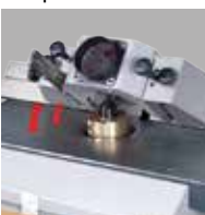
Das MULTI-Einstellsystem mit Parallelführung und Schnelleinstellung
