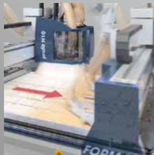
Entladeeinheit, Abschieben der fertigen Werkstücke und Reinigung des Arbeitstisches
