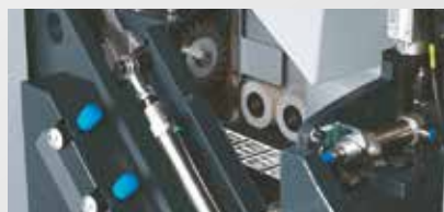
6 Kappsägeaggregat mit 2 unabhängigen Sägeeinheiten
