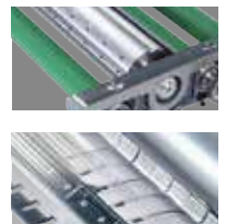
Gummiwalzen, segmentierter Druckbalken
