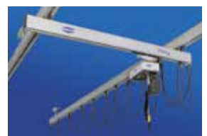
Aluminium-Einträger-Krananlage mit Kettenzug
