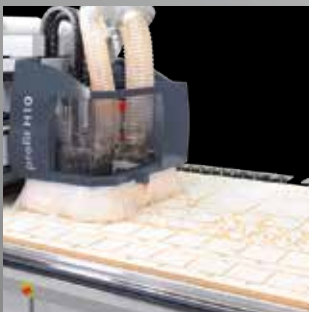
Zuschnitt, Bohren und Fräsen, jede beliebige Form in nur einem Arbeitsgang!
