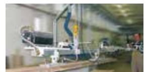
VacuMaster VHB 500 kg Traglast, zur Handhabung von sägeraunen Bohlen
