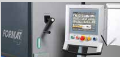
1 Steuerungseinheit mit 10,4"-Touch-Farbbildschirm
