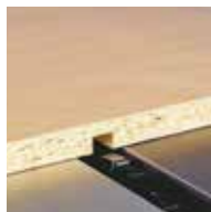
Nuten mit der Kreissäge
