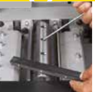
Sekundenschneller Hobelmesserwechsel ohne Einstellarbeiten
