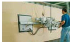
VacuMaster Multi 300 kg Traglast, vertikal zur Beladung von stehenden Sägen
