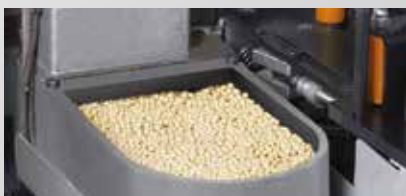
4 Leimaggregate mit optionalem Vorschmelzer
